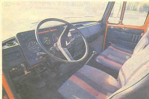
Интерьер кабины ЗИЛ-4331. Новое, меньшего диаметра двухспицевое рулевое колесо обеспечивает лучший обзор приборной панели.
