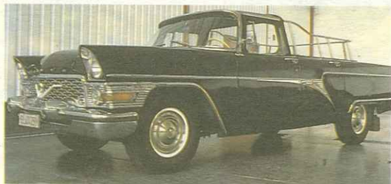
«Чайка» ГАЗ-13 с кузовом «кабриолет» в парадном варианте. Двигатель — V8, 5530 см 3 , 195 л. с./143 кВт при 4400 об/мин.
